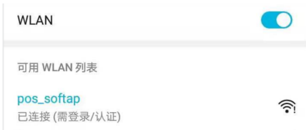
图 19: 连接打开 Captive Portal 功能的 AP
