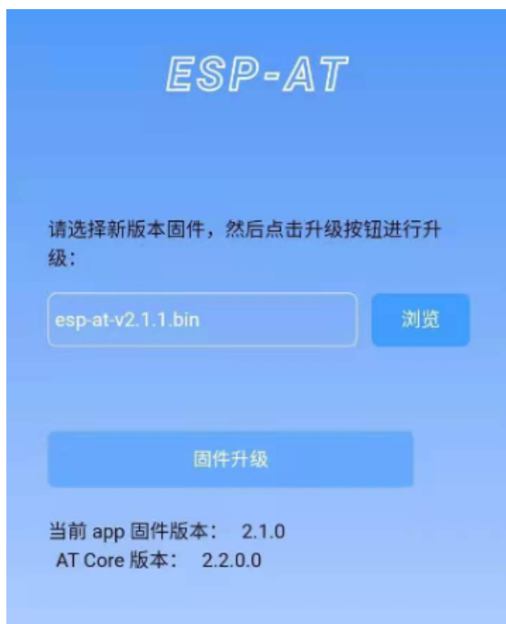
图 7: 选择待发送的新版固件
