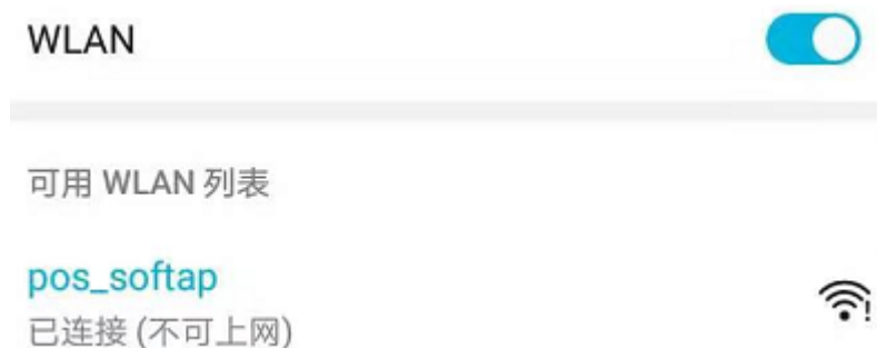
图 1: 浏览器连接 ESP32-C3 AP
